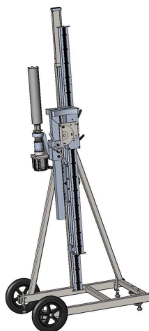
Vue 3D du plan CPO102480 : foreuse à axe vertical orientée vers le haut.
