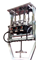
Tête de forage : moteurs brushless, volant et vis d'avance (photo d'illustration)
