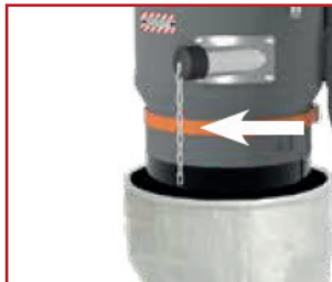
8. Ramener l'intérieur du sac à la hauteur de la sangle, puis fermer le sac autour de la chambre avec cette dernière
