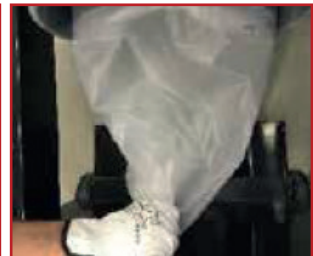
9. Tirer le sac et positionner un collier à l'extrémité pour créer un nouveau sac. Si nécessaire, utiliser deux colliers.
